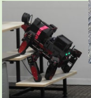
↑ 6脚ロボット ← 階段昇降の様子
