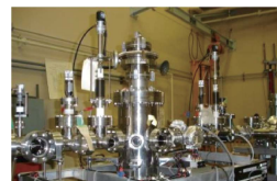
H1低温/高温イオン照射チェンバー
