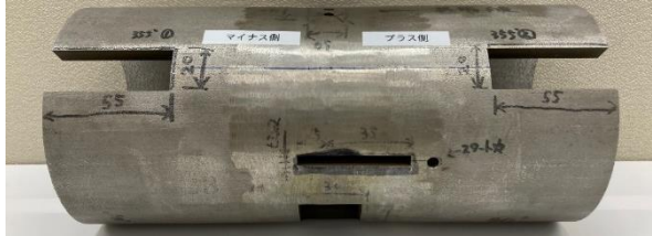
図 1 溶接配管試験体
