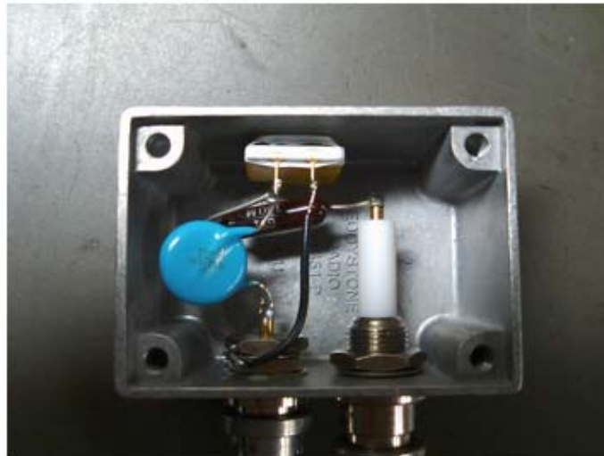
図 4. 検出器内部。APD とシンチレータを光学コンパウンドを用いて密着させ、テフロンテープを巻いてある。それらを機密性の高いアルミケースに入れ、光が入らないようにした。
