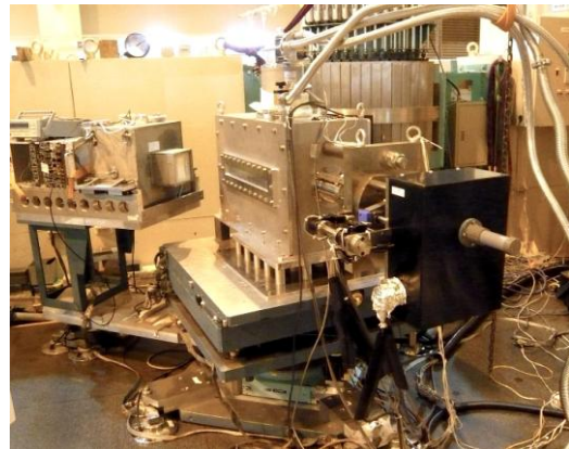
図2 極低温応力負荷装置を同架した残留応力測定用中性子回折装置 RESA
