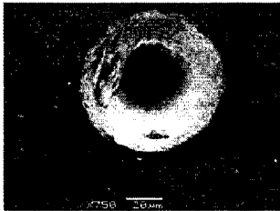
Fig.1: 60 \mu J@800nm, 36sec ウエッジ3回転, 12(sec/round) ポリイミド
