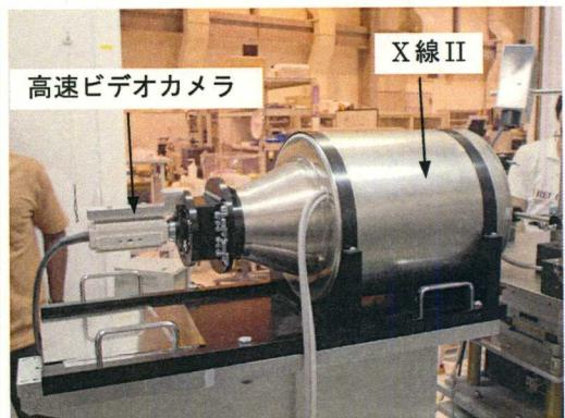
図2. X線II-HSVシステム。
