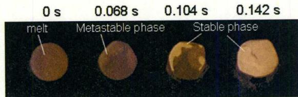
図3.  $\text{YFeO}_3$ 試料の凝固過程。
