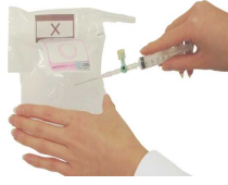
②サンプルバッグから呼気を抜きとります。
