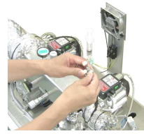
③呼気を導入ポートに注入し、測定の準備をします。
