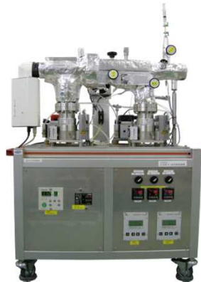
④導入ポートのバルブを開けて測定開始です。
