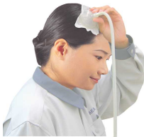
①頭皮などの皮膚に局所ガス捕集器の吸気ノズルをあて、皮膚から排泄される成分をサンプルバッグに集めます。
