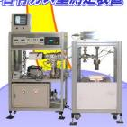
真空ポンプ、真空計、質量分析計、加熱炉に真空天秤を組み合わせた総合機器 (固体から再結晶温度まで加熱して測定)
