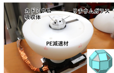
図 1 速中性子イメージャーの構造 (減速材は上半分のみ)
