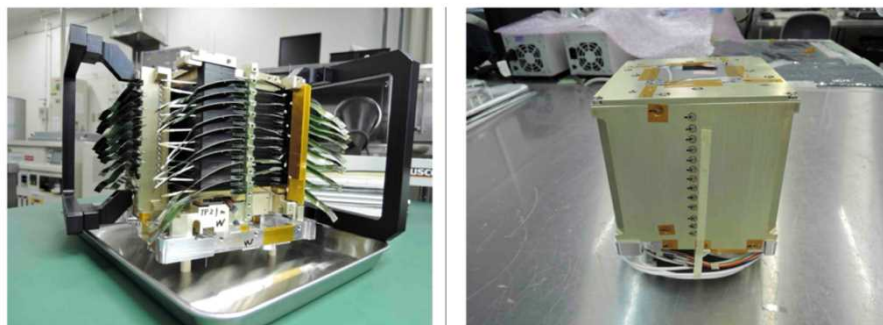
図 1 20 段コンプトンカメラ[3]
