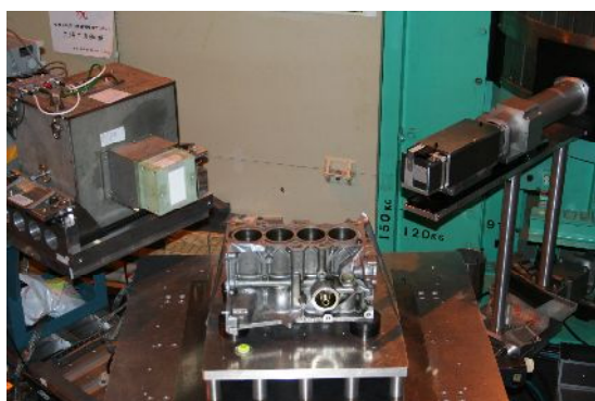
図 1 アルエンジンプロックの残留応力測定状況
