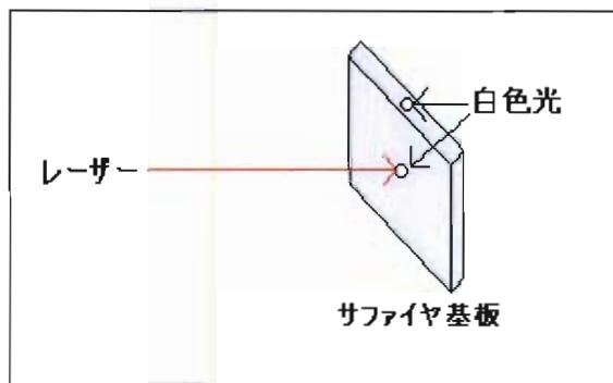
またここで観察されるレーザー焦点位置を基板の裏面に合わせることで、レーザーによる溝を従来のレーザー照射面側ではなく、照射裏面側に入れることができた。観察の結果、裏面側に焦点を合わせて照射した場合、基板表面のデブリや熱影響に関する著しい改善が見られた。
