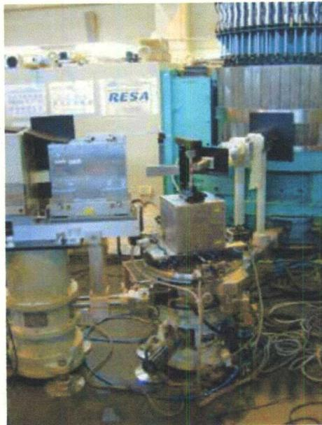
図 1 中性子回折による残留ひずみの測定
