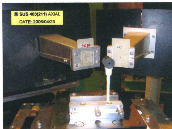
第 3 図 SUS403 部の (211) による AXIAL 測定
